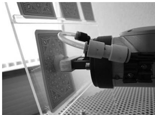
Illustrations 5, 6, 7, 8 : bras articulé Katana. Dans l'exemple ci-dessus, le bras Katana est commandé à l'aide de contacteurs adaptés. Le bras peut-être positionné sur diffé- rents supports et paramétré selon l'activité choisie (images : Centre médico- éducatif de La Castalie, Monthey)
